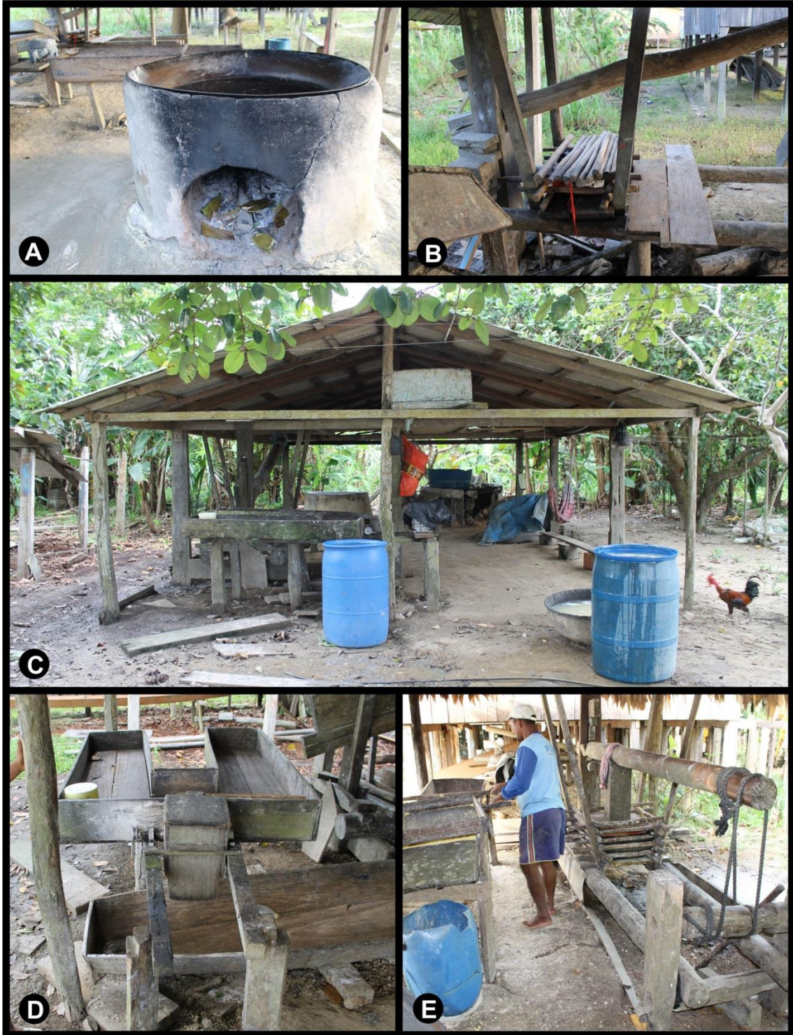
Figura 12 – Representações fotográficas do forno e tacho na casa de farinha, capital material da casa de farinha (A); Prensa da casa de farinha (B); Casa de farinha comunitária, capital material da família comunitária (C); Instrumento para cevar a mandioca ( Manihot esculenta ), é possível notar a uma canoa reaproveitada para esse fim (D) e; Homem trabalhando na ferramenta de cevar a mandioca, detalhe para a prensa, na casa de farinha comunitária (E.). Complexo Ambiental Sacaiá. Município de Caracaraí. Estado de Roraima. Brasil 2015.
